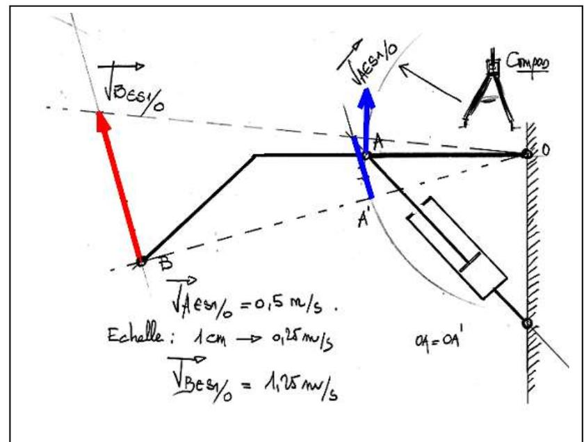
On en déduit par mesure  $\mathbf{VB} \in S_1/S_0$  puisque la norme du vecteur vitesse est proportionnelle au rayon de la trajectoire du point.
