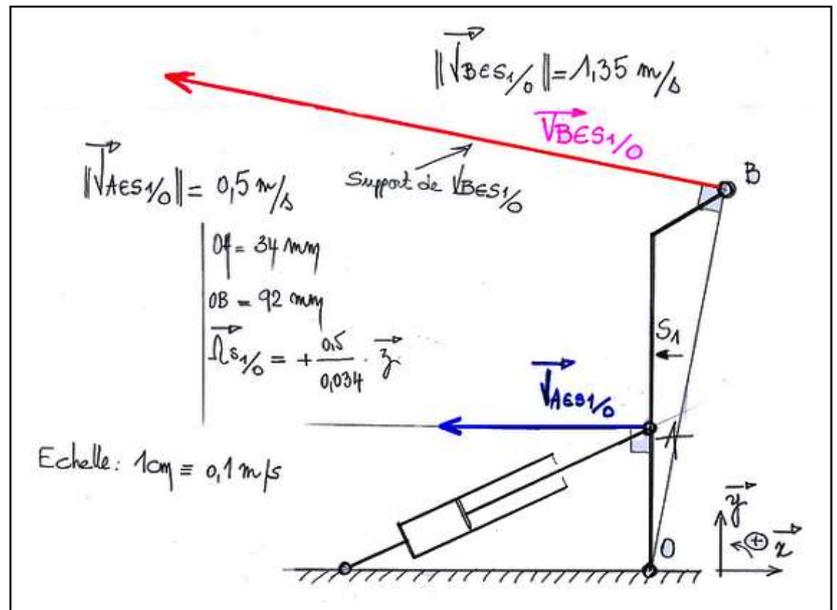
On représente à l'échelle  $\mathbf{VA} \in S_1/S_0$ . Avec le compas, on reporte le rayon OA sur le segment OB, on obtient le point A' qui a la même vitesse (scalairement) que le point A. On trace à la même échelle le vecteur vitesse  $\mathbf{VA}' \in S_1/S_0$ . On joint l'extrémité de ce dernier au point O et on prolonge jusqu'à couper la perpendiculaire à OB en B.
