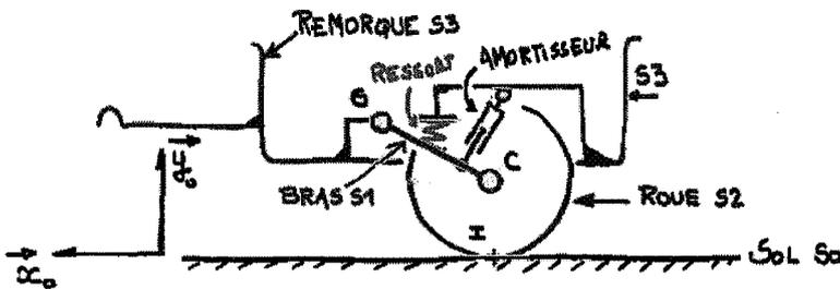
Le schéma ci-contre représente une remorque  $S_3$ . L'essieu arrière est articulé en G. Un bras ( $GC=l$ )  $S_1$  est en liaison pivot ( $GZ$ ) avec la remorque ; les roues  $S_2$  sont en liaison pivot ( $CZ$ ) avec le bras.
