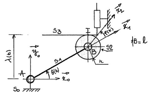
Le moteur fait tourner la roue dentée  $S_2$  qui roule sans glisser sur  $S_3$ .
