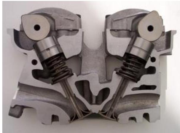
Coupe d'un moteur, montrant les cames au-dessus des soupapes
